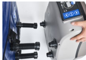
3) Svitare le tre raccordi del blocco motore..
