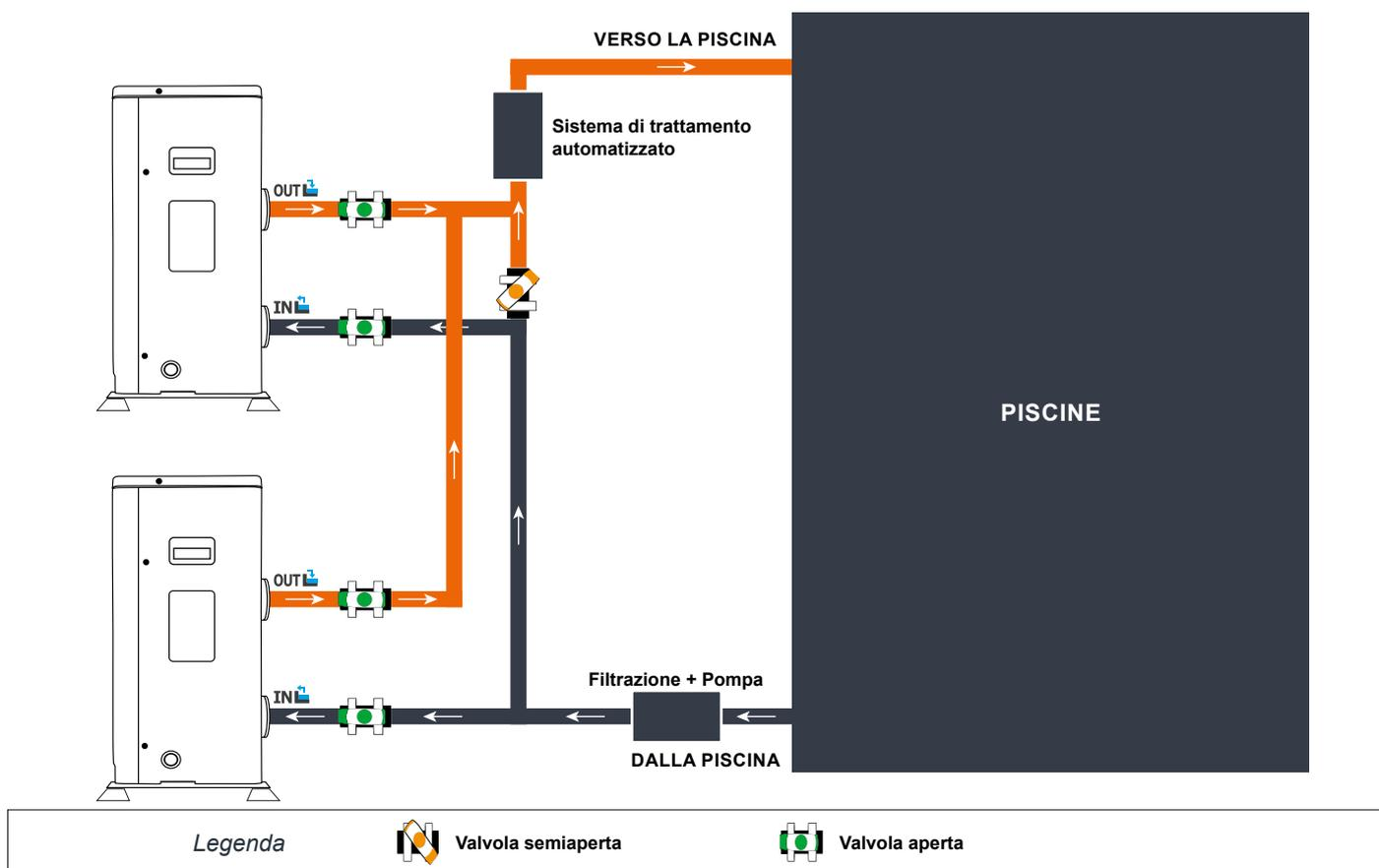
Il filtro a monte della pompa di calore deve essere pulito regolarmente affinché l'acqua del circuito sia pulita e, in tal modo, si evitino problemi di funzionamento dovuti alla sporcizia o all'intasamento del filtro.
