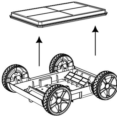
c. Nettoyez le plateau de filtration et le châssis
