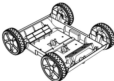
c. Montare il rivestimento superiore del pulitore procurando di fissarlo saldamente al telaio.
